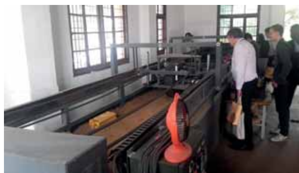
Zwiedzanie Jiangsu Center for Agricultural Machinery Testing and Evaluation w College of Engineering, Nanjing Agricultural University (NIAU) (stanowisko do badań narzędzi uprawowych i oddziaływania kół na glebę)
