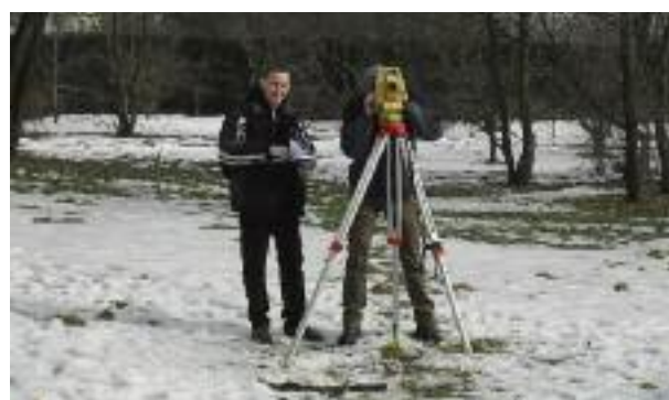
Pozyskiwanie informacji o położeniu obiektów w ogrodzie za pomocą tachimetru elektronicznego
