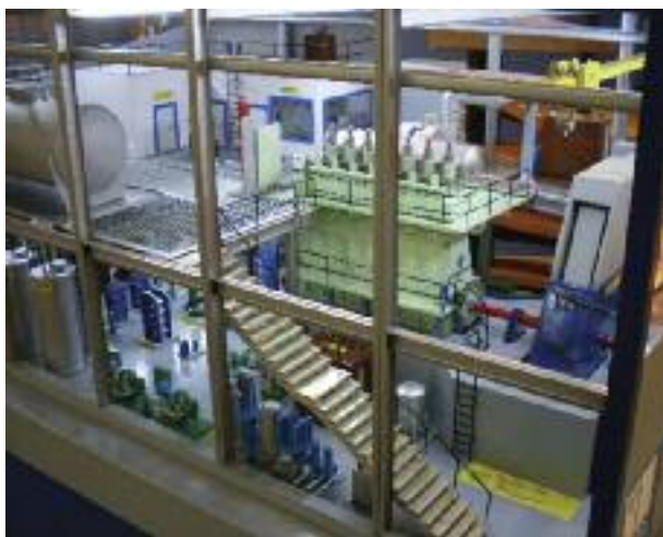
Makieta elektrowni z silnikiem 7L35MC-S działającej w systemie kogeneracji na biopaliwie z nieoczyszczonego oleju palmowego
