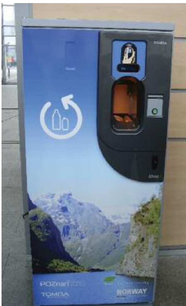
Maszyna naliczająca kaucję za zużyte opakowania po napojach student IV roku inżynierii środowiska
