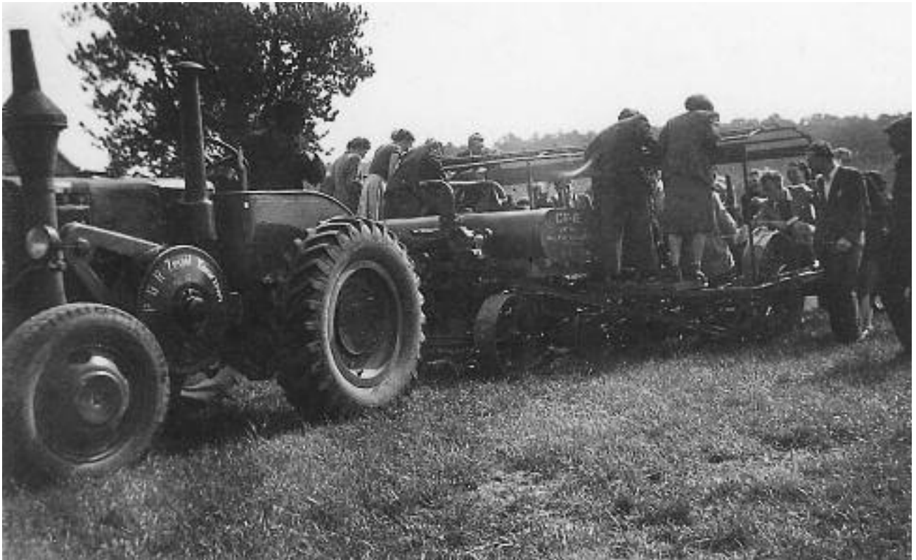
Połowa lat pięćdziesiątych XX wieku, pierwszy polski ciągnik z silnikiem dwusuwowym Ursus C45, 10 200 cm 3 , 45 KM, jeden cylinder, silnik średnioprężny... Witold Woyke wspomina do dziś zachwyty, z jakim ów sprzęt przyjmowali studenci
