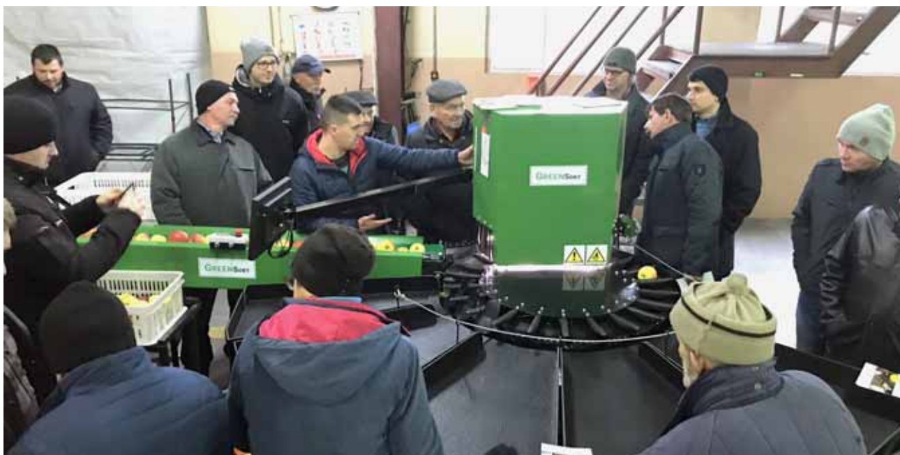
Pokaz pracy kompaktowej sortownicy polskiej firmy GreenSort
